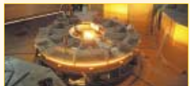
Zwierciadło do teleskopu o średnicy 8,2 m wykonane z ceramiki szklanej. Fot. Schott
