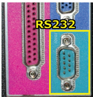
3. Port RS232 w komputerze Dell OptiPlex 745
