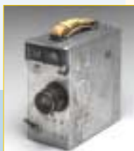
Kamera z 1927 r. wykonana z duraluminium
