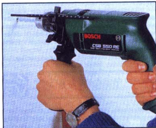
Prawidłowe posługiwanie się wiertarką, wyposażoną w dodatkowy uchwyt, mocowany na kołnierzu
