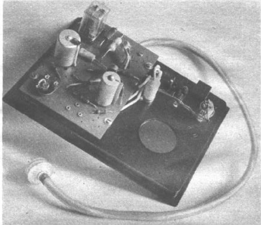
Automatyczny wyłącznik odbiorników TV. Fot. u góry przedstawia zmontowane elementy wyłącznika, fot. u dołu — elementy sterownicze urządzenia
