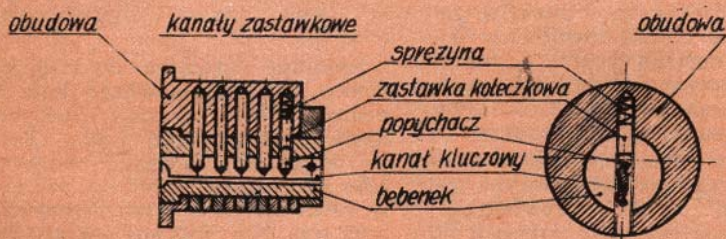
Rys.32 Mechanizm zastawkowy w przekroju podłużnym i poprzecznym.
