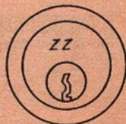
Rys.26 Tarcza z profilowanym otworem kluczowym
