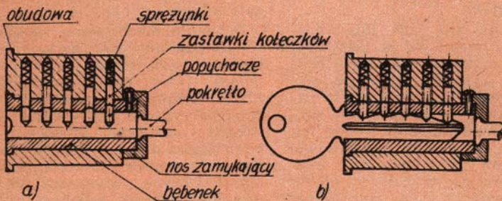
Rys.32 Mechanizm zastawkowy w przekroju podłużnym i poprzecznym.
