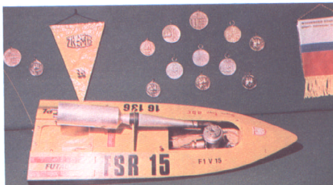
Model łodzi z silnikiem spalinowym o mocy 2 KM przy 22 tys. obr./min. Osiąga on prędkość 70 km/h. Wykonany został przez Marka Michalskiego
