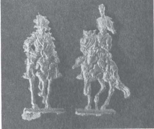
Fot. 1. Dwie figurki żołnierzyków bezpośrednio po wycięciu ich z formy
