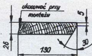
Przekrój przez poprzeczkę skrajną
