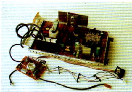
Kompletny blok odchylenia wraz z płytką kineskopu i przewodem WN
