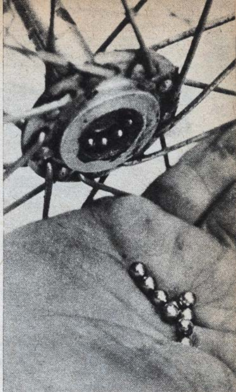
Fot. 11. Wymiana kulek tożyskowych w płaszcie przedniej
