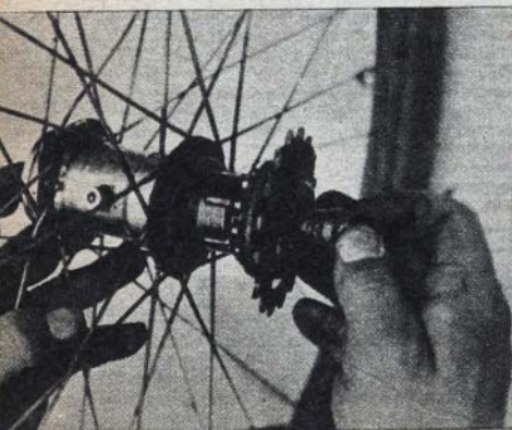
Fot. 12, 13, 14. Rozbieranie tylnej piasty koła rowerowego (torpedo)
