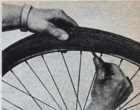
Fot. 1. Zdejmowanie opony za pomocą łyżki
