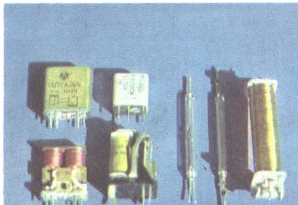
Przekaźniki kontaktronowe i elektromagnetyczne nadające się do pracy w odbiorniku
