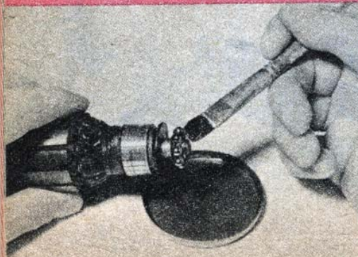
Fot. 5. Czyszczenie łożysk kulkowych
