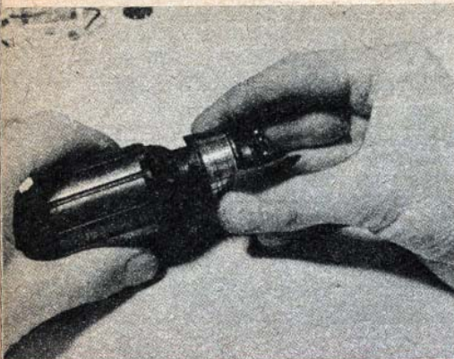
Fot. 4. Regeneracja komutatora; czyszczenie komutatora za pomocą papieru ściernego
