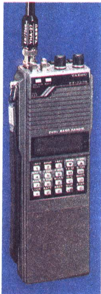
Fot. 5. Przenośne radiotelefony FM – podręcznym narzędziem każdego krótkofalowca-amatora. Na zdjęciu radiotelefon FT 727 R na pasmo 430/144 MHz
