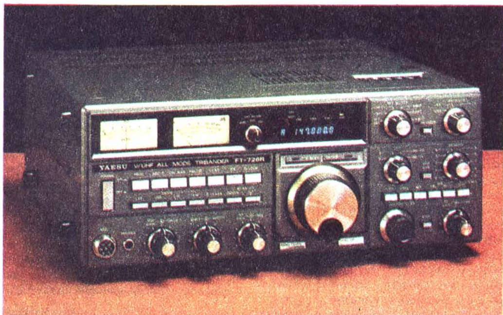
Fot. 4. Transceiver FT 726 R – wszystkie emisje i wszystkie pasma (UHF i VHF) łącznie z wyższymi pasmami KF – oto współczesne tendencje w sprzęcie łączności
