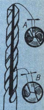
Rys. 15 Grubość ściu w części roboczej wiertła
