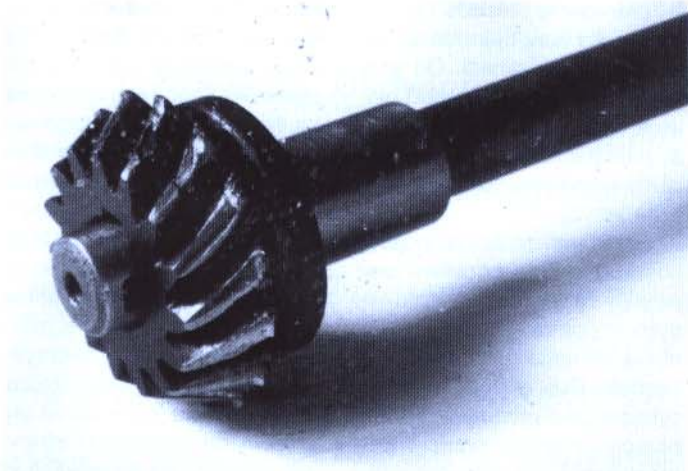
Koło zębate silnika wodnego zniszczone w wyniku braku smarowania
