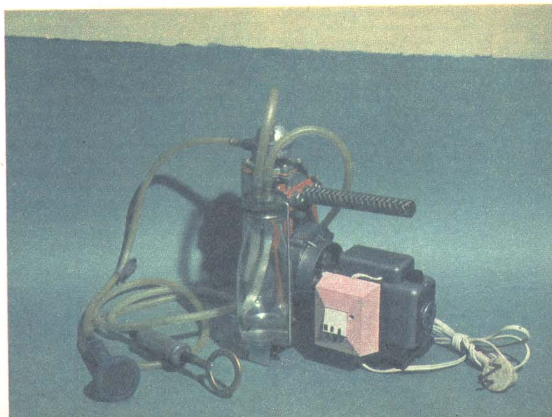
Silnik i pompa elektrycznego prysznica
