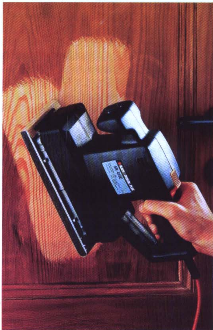
Szlifowanie drewna Mechaniczne usuwanie starej powłoki lakierowej z dużych, jednorodnych powierzchni można sobie ułatwić używając elektrycznej szlifierki oscylacyjnej.
