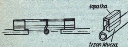
Rys. 59 Sposób wyznaczania profilu klucza na surowej topatce.
